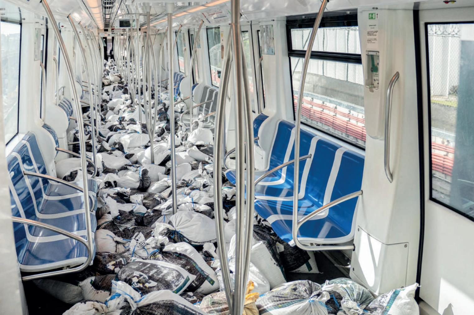
El 22 de agosto se dio un nuevo avance con la primera prueba bajo condiciones de carga real. Para ello se colocó un peso equivalente a 54 toneladas métricas en un tren, simulando la capacidad total de usuarios. Durante el recorrido se verificaron la tracción, el frenado, las vibraciones en túneles y viaductos, el consumo eléctrico y el comportamiento general de la infraestructura bajo demanda real.
